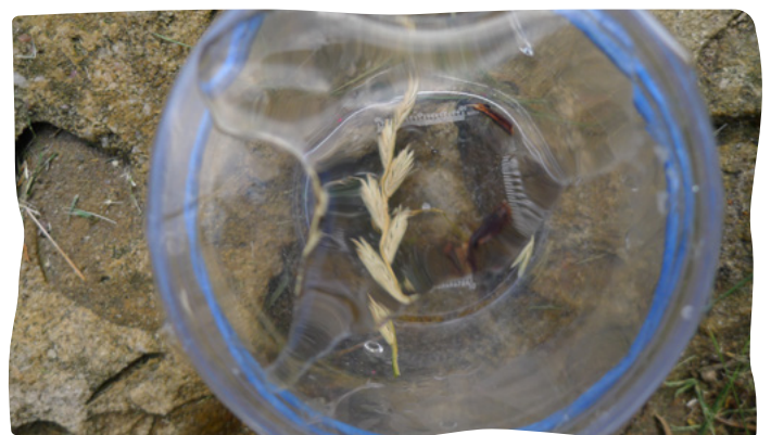
Kelímkové lupy lze vyrobit z průhledného kelímku, folie, gumičky a kapky vody. Získáme 2× zvětšení.
